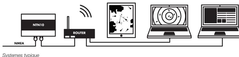
“Le NTN10 permet aux données NMEA 0183 de navigation d’être raccordés au réseau, permet le partage du même câblage et permet aux périphériques connectés au réseau d’utiliser ces données NMEA”
