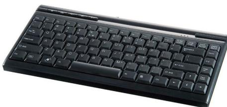
Clavier USB compact pour une utilisation avec notre gamme de PC Aqua (P/No. ZDIGKB05). Ce clavier est équipé avec deux ports USB pour que vous puissiez connecter un dongle ou une clé USB.
