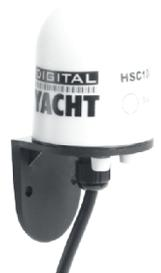
Der HSC100 ist ein Präzisions Fluxgate Sensor mit NMEA 0183 Ausgabe. Es kann für eine schnellen 6-Hz-Ausgabe zur Radar Stabilisierung programmiert werden und ist auch als HSC100T mit synthetisierten wahren Norden und ROT Informationen erhältlich - ideal für den Einsatz mit Klasse A AIS-Systemen
